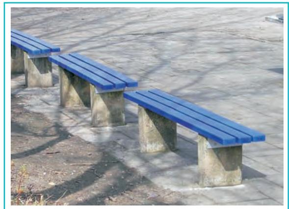
Bankbohlen Typ Komfort mit einem maximalen Stützabstand von 145 cm montieren.
