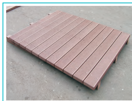
Pos. 1 - Stegbohlen Pos. 2 - Unterkonstruktion aus Vierkantprofilen, schräg angeordnet, einseitig überstehend Pos. 3 - Verschraubung mittels Edelstahl-Senkkschrauben
