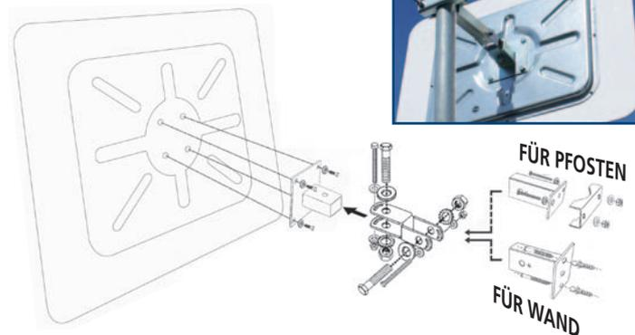
Universal-Halterung aus feuerverzinktem Stahl, für Wände und Pfeiler. Für Rundpfosten (Ø 76 bis 90 mm) oder Vierkantspfosten (60x80 oder 80x80mm). Erlaubt eine sehr präzise Einstellung der Spiegelposition. **Ausschließlich zur Montage auf Stahlpfosten geeignet.**
