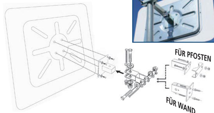
Universal-Halterung aus feuerverzinktem Stahl, für Wände und Pfeiler. Für Rundpfosten ( $\varnothing$  76 bis 90 mm) oder Vierkantspfosten (60x80 oder 80x80mm). Erlaubt eine sehr präzise Einstellung der Spiegelposition. **Ausschließlich zur Montage auf Stahlpfosten geeignet.**
