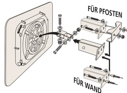
Universal-Halterung aus feuerverzinktem Stahl, für Wände und Pfeiler mit einem Querschnitt von 60 bis 90 mm. Erlaubt eine sehr präzise Einstellung der Spiegelposition. Widerstandsfähigkeit wurde getestet bei Windstärken bis zu 183km/h.
