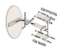
Universal-Halterung für Wände und Pfeiler mit einem Querschnitt von 60 bis 90 mm. Erlaubt eine sehr präzise Einstellung der Spiegelposition. Widerstandsfähigkeit wurde getestet bei Windstärken bis zu
