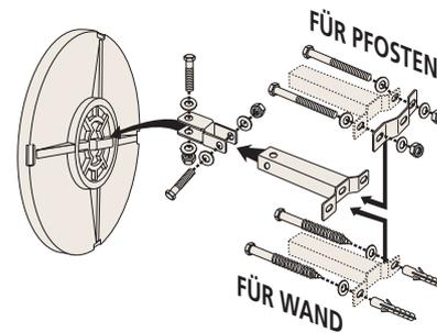
Universal-Halterung aus feuerverzinktem Stahl, für Wände und Pfeiler mit einem Querschnitt von 60 bis 90 mm. Erlaubt eine sehr präzise Einstellung der Spiegelposition. Widerstandsfähigkeit wurde getestet bei Windstärken bis zu 183km/h.
