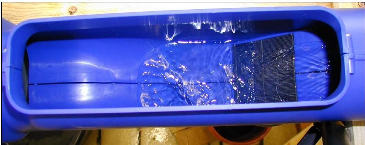
Abbildung 5: INTEWA Wechselsprungfilter WSP100 mit  $Q = 0,2$  l/s
