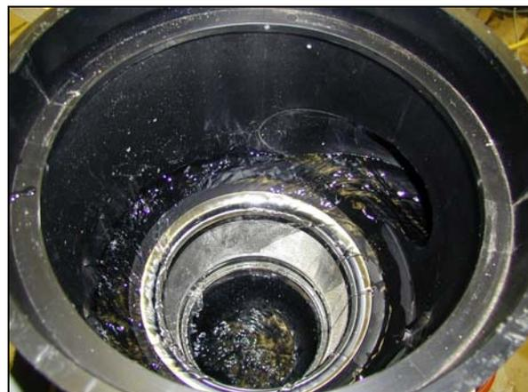
Abbildung 21: (rechts) WISY WFF-100 mit  $Q = 0,1l/s$  (gegen Ende des Versuches)
