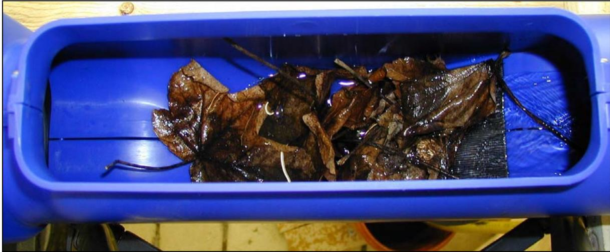
Abbildung 6: INTEWA Wechselsprungfilter WSP100 mit  $Q = 0,2 \text{ l/s}$  mit Verschmutzung
