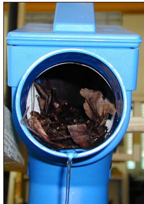
Abbildung 13: (rechts) 3P Patronenfilter PF mit  $Q = 0,2 \text{ l/s}$  und Verschmutzung (Laub)
