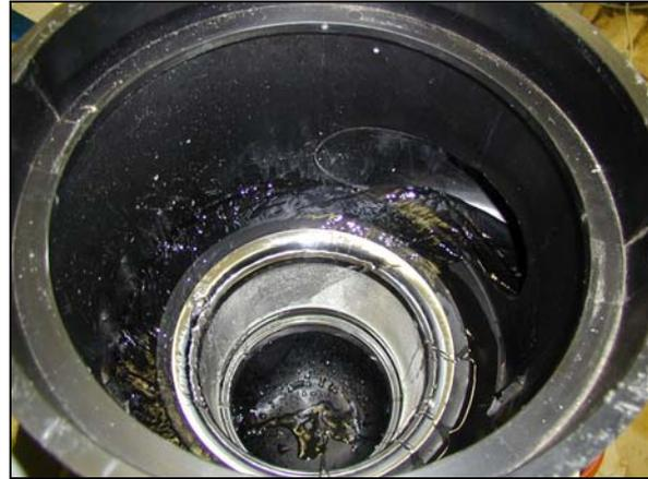
Abbildung 19: (rechts) WISY WFF-100 mit  $Q = 0,11/s$  (gegen Ende des Versuches)
