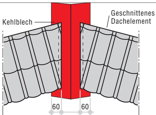
Geschnittenes Dachelement 60 mm in das Kehlblech führen und **ca. 20 mm abkanten**.
