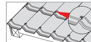
Die überdeckenden Platten werden gemeinsam an jedem Wellenberg, mittig zwischen der Doppelwulst mit **Spezialnägeln mit Kunststoffkopf** befestigt.
