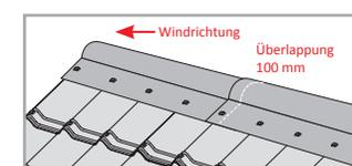
Die firstseitige, obere Reihe der Elemente wird zusammen mit der Firsthaube (auch als Ortgang verwendbar) verlegt und mit **Spezialnägeln mit Kunststoffkopf** befestigt.
