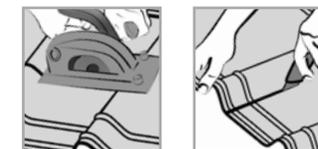
Der Zuschnitt erfolgt mit einer Stich- oder Kreissäge, bzw. mit einem Cutter.
