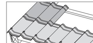
Die zweite Reihe ist mit einem zugeschnittenen Element anzufangen und entsprechend Doppelwulst auf Doppelwulst zu verlegen.
