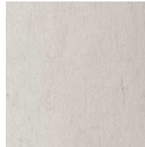
Sichtbeton (Schalungsglatte Beton, Rücken geglättet)
