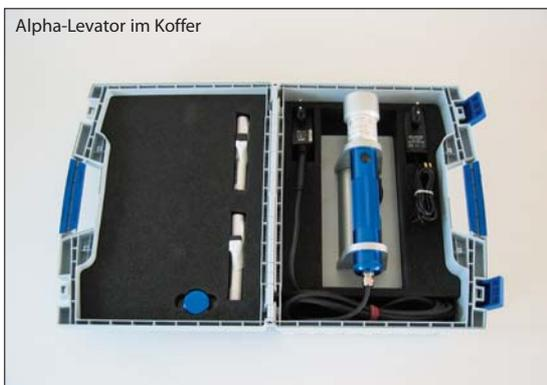
Alle glatten / rauen und luftundurchlässige Platten, wie z.B. Fliesen, Naturstein-, Betonplatten, Kunststoffe, Bleche oder Glas können mit dem Alpha-Levator auf einfache Weise gehoben werden: sofort nach dem Aufsetzen saugt sich die Platte fest, kann angehoben und transportiert werden. Der Alpha-Levator gibt die Platte erst wieder frei, wenn Sie es wollen: hierzu wird durch Tastendruck ein Ventil geöffnet. Wandfliesen können mit dem Gerät auch in die Vertikale geschwenkt werden.
