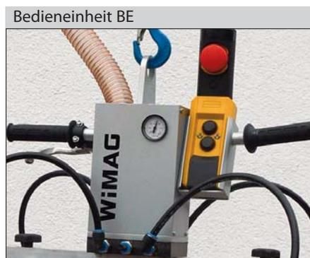
Die Bedieneinheit BE wird in den Lasthaken des Hebezeuges eingehängt. Die Last wird mit den beiden Griffen geführt. Mit dem Belüftungsgriff kann die Last gelöst werden. Die Bedieneinheit ist mit einem Manometer und einem Halter für den Steuertaster des Hebezeuges ausgestattet.
