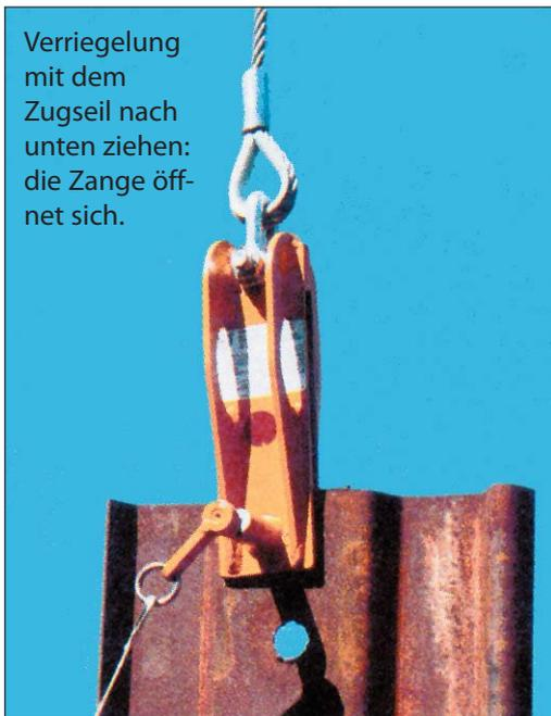
Verriegelung mit dem Zugseil nach unten ziehen: die Zange öffnet sich.
