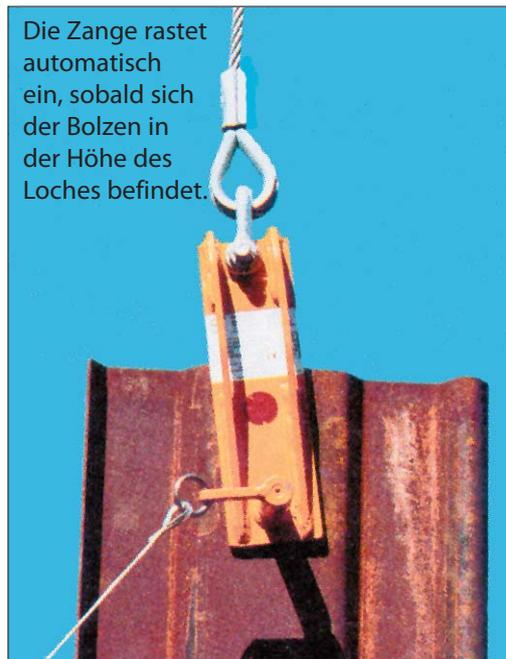
Die Zange rastet automatisch ein, sobald sich der Bolzen in der Höhe des Loches befindet.
