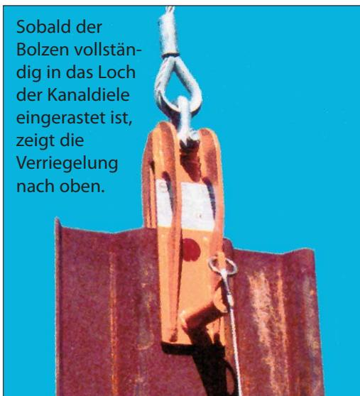
Sobald der Bolzen vollständig in das Loch der Kanaldiele eingerastet ist, zeigt die Verriegelung nach oben.
