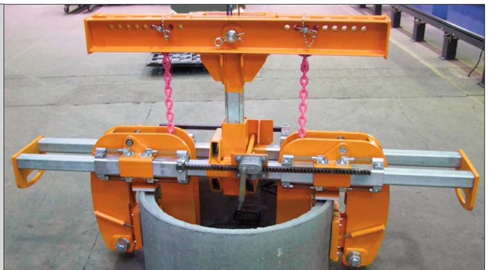
Rohrgreifer RG 10 mit gleichzeitiger, stufenloser Einstellung auf die Nennweite über Zahnstangenwinde
