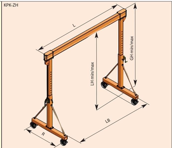
Der Bockkran **KPK** ist für den Einsatz eines hand- oder elektrisch betriebenen Hebezeuges in der Halle und im Freien geeignet. Er ist auf ebenem, festem Boden gut verfahrbar. Die lichte Breite LB kann durch die Klemmverbindung zwischen Stützen und Träger stufenlos verstellt werden. Der Kran ist leicht montierbar und zerlegbar. Die beiden Fahrwerke sind mit Lenkrädern mit Vierfach Lenkstopp ausgestattet, zwei Räder haben zusätzlich einen Radstopp.
