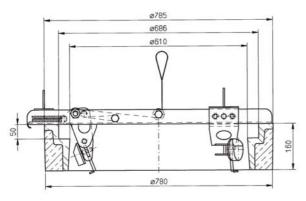
\* Die Lüftungsöffnungen der Hersteller sind nicht genormt. Daher kann nicht garantiert werden, dass die beiden Lasthaken für jeden Deckel passen.
