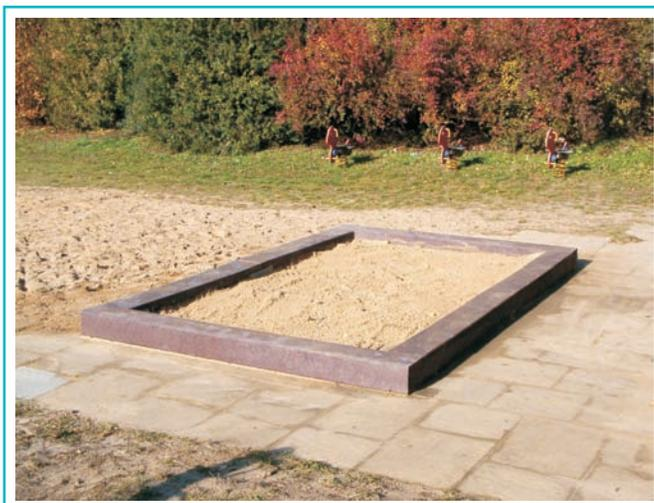
Bei liegendem Verbau von Recyclingprofilen muss ein Verlegeabstand eingehalten werden, um die temperaturabhängigen Längenschwankungen der Profile (bis +/- 1,5 %) abzufangen. Ansonsten können sich die Profile bei Ausdehnung gegenseitig verschieben. Auch bei der Fixierung auf ein Fundament ist dieser Effekt zu berücksichtigen (z.B. Verschraubung mit Langlöchern). Die Spalten können mit dauerelastischen Dichtstreifen oder Moosgummi verschlossen werden.
