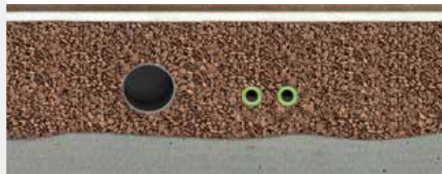
Massivdecke mit Trockenestrich
