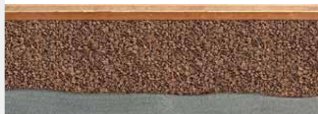
Massivdecke mit Holzfaserplatte
