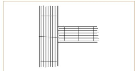
Abb. 3: Anbringen des Schilfrohrgewebes auf den Holzbalken
