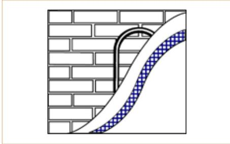
Abb. 4: Einputzen der Wandheizungsrohre
