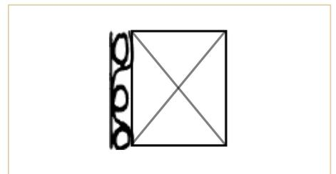
Abb. 3: Schilfrohr-Putzträger auf Holzbalken
