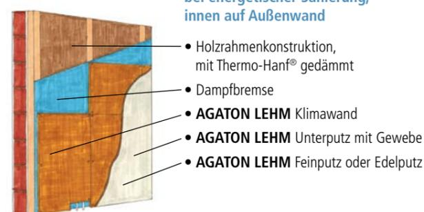
Die **AGATON LEHM** Klimawand besteht aus einer 22 mm starken, qualitativ hochwertigen Lehmplatte, die neben Lehm aus Sand und Glasgittergewebe hergestellt wird. Die wasserführenden Verbundrohre sind werksseitig in der Platte eingearbeitet. Sie ist in Endstücken und Verbindungselementen in den Holzrahmenbaumaßen 1.250 x 625 mm bzw. 625 x 625 mm verfügbar. Die benötigte Verbindungstechnik und Verschraubung wird analog der Plattenanzahl für die zu verkleidende Gesamtfläche bei Bedarf mitgeliefert.
