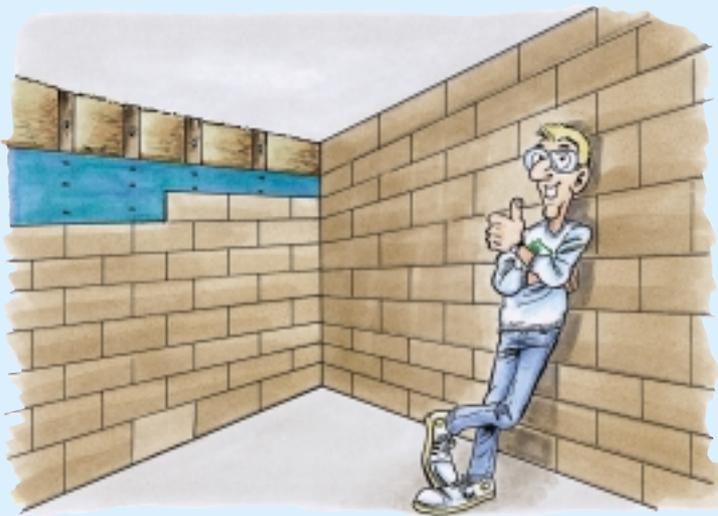
Nach dem Einbau der Dämmung + Dampfbremse verkleidet Theo Thermo den Raum mit Lehm- bauplatten. So sieht ein zufriedener Bauherr aus.
