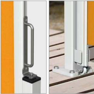
Mit dem **Handgriff** wird die Micro 700 einfach ausgefahren und am Mast eingehakt. Die **Bodenrolle** ermöglicht eine leichte Führung. Für eine sichere und komfortable Handhabung ist die Tuchwelle mit einer **Rückschlagbremse** ausgestattet.
