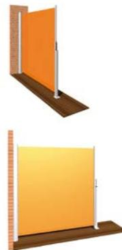
Verschraubung am Boden mit Bodenkonsole
