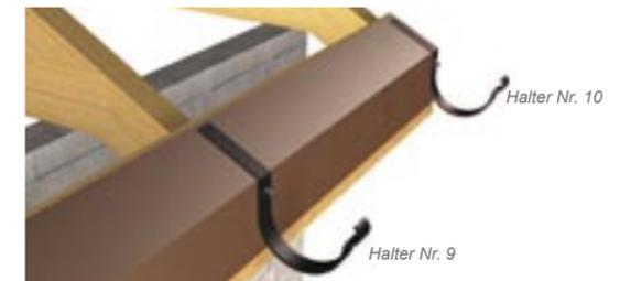
Die Halter werden von Nr. 1 bis 10 angebracht. Der Halter Nr. 10 ist am niedrigsten gelegen (direkt an dem Stützen).
